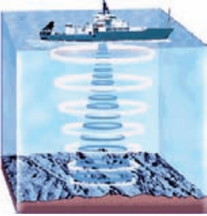
Şekil 1. Echo-sounder ile deniz tabanı araştırma yöntemi.
